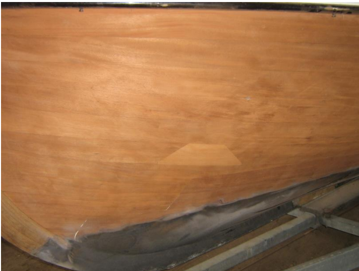
Eine der Schadstellen oberhalb der Wasserlinie
