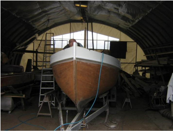
Erste Schleifarbeiten außen
